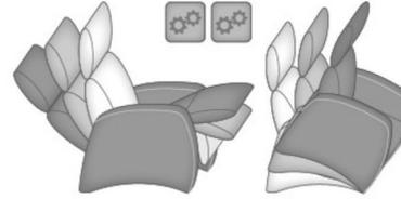
Stufenlose Verstellung der Beinauflage und Rückenlehne durch zwei Elektromotoren mit zusätzlicher Aufstehhilfe (max. 160kg).
