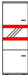
Abb.1 - schmaler Glasauschnitt: Montage der LED-Schienen erfolgt waagrecht hinter den 2 Holzböden (oben + unten). Montage erfolgt vor Ort !
